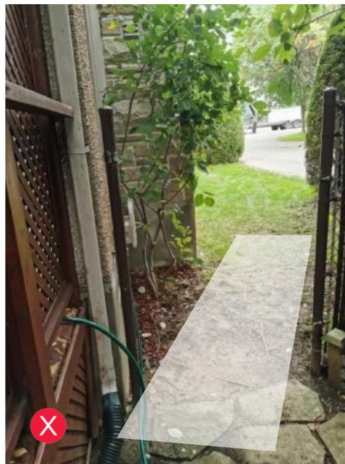
La présence d'un balcon et d'une colonne de la maison empêche de faire passer le spa en ligne droite par l'espace de la porte de la clôture et ainsi, de respecter le 42" de largeur minimale requise.
